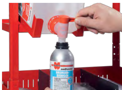
Bus met werkzame vloeistof vullen. Deksel dichtschroeven.
