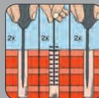
Bohrlöcher reinigen (2x ausblasen / 2x ausbürsten / 2x ausblasen)
