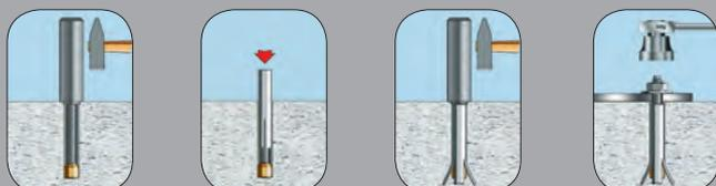
Gewindebolzen ohne Vorbohren mit Setzwerkzeug bündig einschlagen
