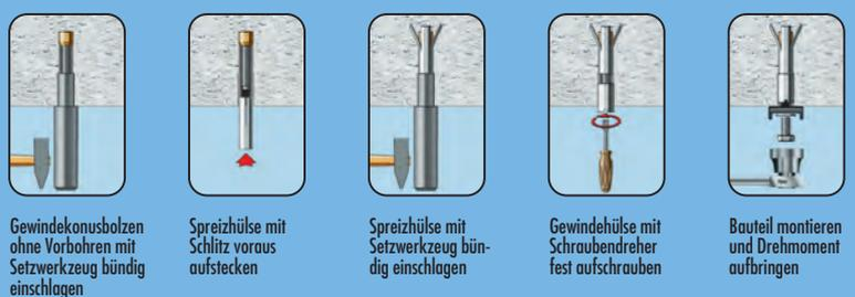
Gewindekonusbolzen ohne Vorbohren mit Setzwerkzeug bündig einschlagen
