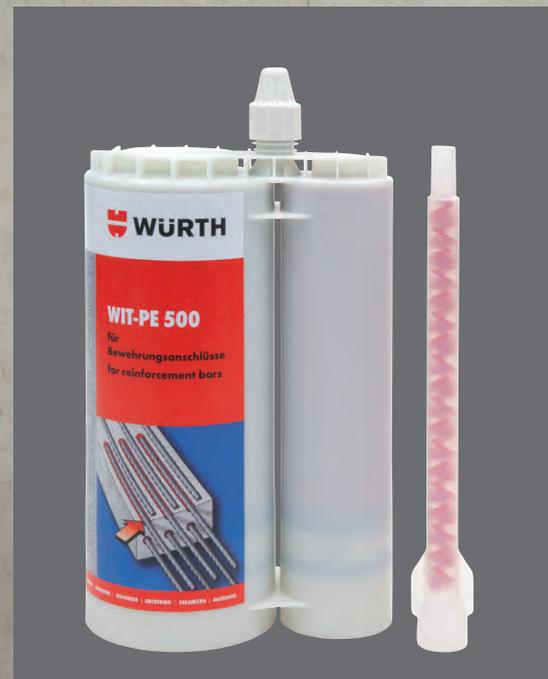
Mit unserem WIT-REBAR System können Bewehrungsstäbe nachträglich in Beton C 12/15 bis C 50/60 bis zu einer Setztiefe von 280 cm verankert werden. Der Injektionsmörtel WIT-PE 500 besitzt eine allgemeine bauaufsichtliche Zulassung (Z-21.8-1834) und eine europäisch technische Zulassung (ETA-07/0313) für Stabdurchmesser 8 bis 28 mm sowie Zuganker M12, M16 und M20.
