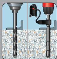
Bohrloch herstellen. Bei Verwendung des Saugbohrers kann eine zusätzliche Bohrlochreinigung entfallen.
