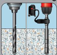
Bohrloch herstellen. Bei Verwendung des Saugbohrers kann eine zusätzliche Bohrlochreinigung entfallen.
